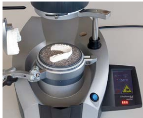
8. Achtung , der automatisierte Tiefziehvorgang beginnt. Quetschgefahr!
