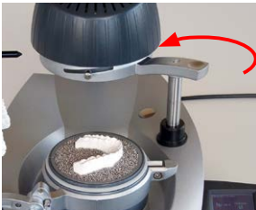
7. ... unter die Heizung schwenken. Der Heizvorgang startet.
